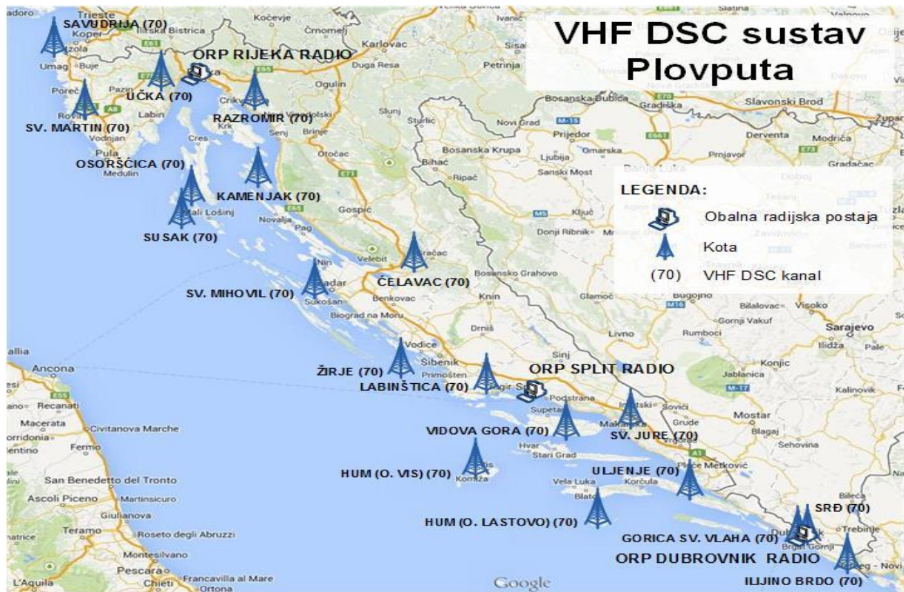
Slika 1. Kote sa pripadajućim baznim postajama VHF DSC sustava Plovo Plovputa
